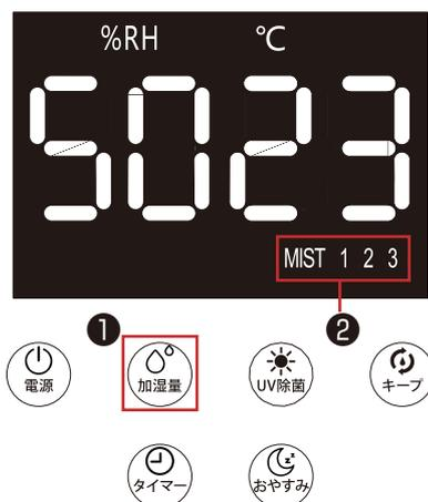
加湿量ボタン（左図①）をタッチすることで、加湿量の調整ができます。
