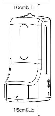
3-2. 水平になるよう位置を調整し設置場所を決定します。
