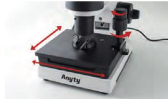
血流が見える場所を探しやすい、X-Yステージ搭載。ダイヤルをX-Y軸各方向に回すと、観察位置を微調整できるので、観察範囲が狭く、探しづらい血流を見つけやすくなります。
