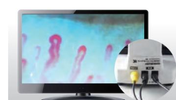
200万画素のカメラで撮影した血流の映像を8型のモニタに映し出すことができます。また、本体にAV出力のポートがあるのでTVモニタでも観察することができます。
