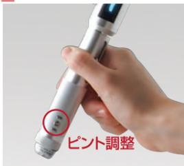
自分でピントを合わせる手間なく、ワンタッチで勝手にピントが合います。さらに、特許技術の液体レンズを搭載しているため通常のオートフォーカスと比べ短時間で瞬時にピントが合います。また、様々なアタッチメントがあり、肌、頭皮観察には標準アタッチメントを、血流観察時は血流アタッチメントを装着。アタッチメントは簡単に着脱でき、オプション品として温度測定用・頭皮血流用、低倍率用があります。
