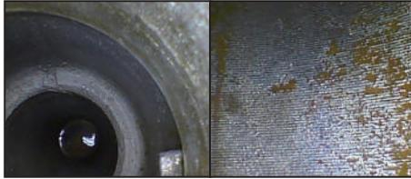
φ6.0mm/φ9.0mmはデュアルカメラを搭載。側面にもレンズがあり、側視ミラーを取り付けることなくボタン切替1つで直視・側視の確認ができます。
