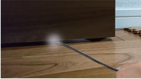
目では確認できない狭い場所や高い場所など、Φ8mmの極細ケーブルが奥まで入り込み2.4型のモニタに映し出します。
