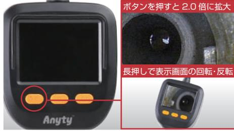
本体左側にある拡大／回転のボタンを押すたびに、デジタルズームで最大2.0倍まで拡大表示されます。また、ボタンを長押しすることで表示画面の回転・反転します。
