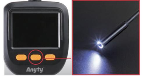
ケーブル先端に搭載された6灯のLEDライトを5段階に調光できます。使用場所に合わせてお好みの明るさで観察・点検が可能です。
