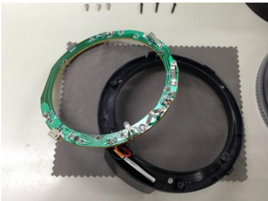
9) ボックスから充電電池を取り出し、ケーブルを切断します。
