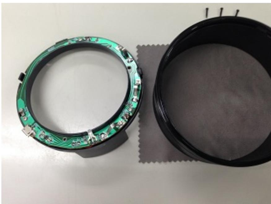
7) 基盤面に見えるネジ3か所を外します。
