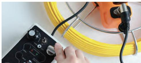
スイッチコンソールに SDHC カードもしくは USB メモリをセットする。
