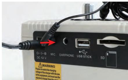
※ピンマイクで録画した音声を聞くには、EARPHONE 端子にイヤホンを取り付けて聞きます。音量は、パワーコンソールの△▽で調整を行います。
